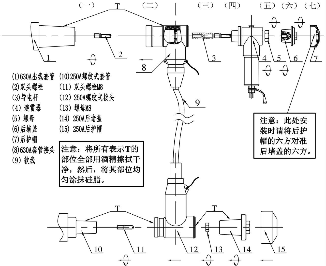
2.1 开关出线套管带避雷器组装后的示意图
